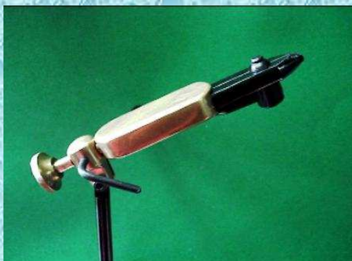
Morsetto con testina rotante
